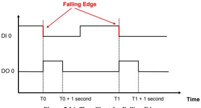
Figure 7.34: Time Chart for Falling Edge
