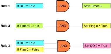
Figure 7.33: GCL Logic for Rising Edge
